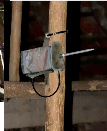
Abb. 3a: In den Dachbereichen wurden Detektierungen und automatische Erfassungen von Fledermäusen vorgenommen.
