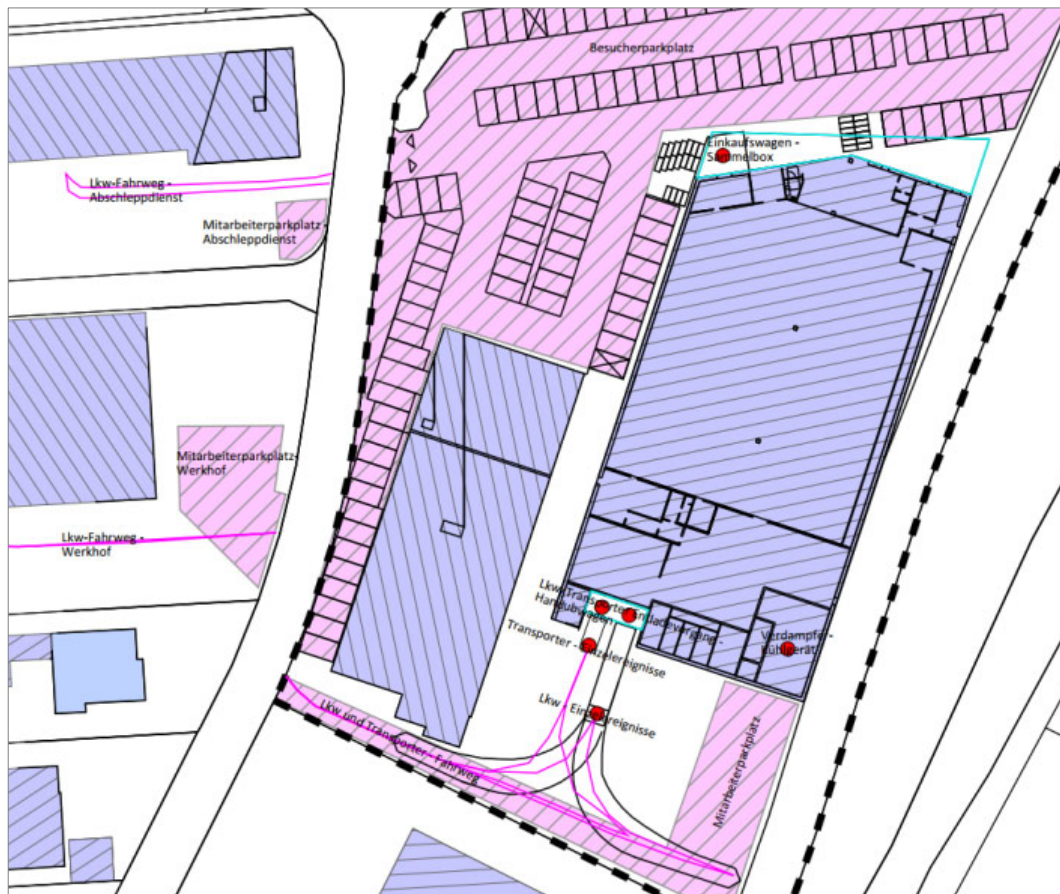
Abbildung 2: Schallquellen des Nahversorgers und Umgebung (Auszug, Anlage 1)
